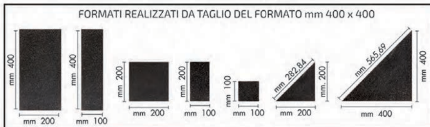
FORMATI REALIZZATI DA TAGLIO: 200x400 mm - 200x200 mm - 100x400 mm - 100x200 mm - 100x100 mm
